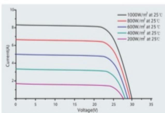
Вольт-Амперная характеристика в зависимости от интенсивности инсоляции:
